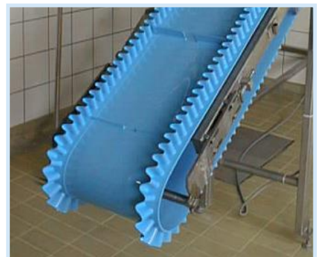
SuperDrive™ mit Wellenkanten und Spezialstollen
